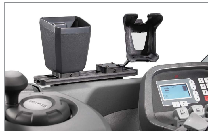
Крепление для вспомогательных устройств (опция)
